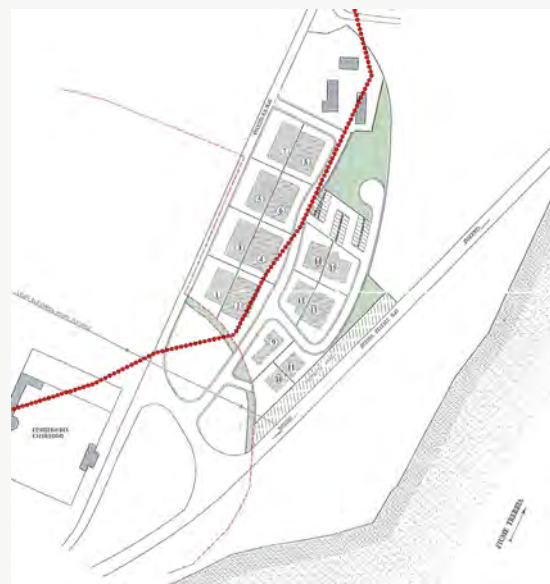
Figura 2 – Area di progetto in rapporto all'area vincolata del Trebbia. La linea rossa indica il limite di 150m dal fiume
