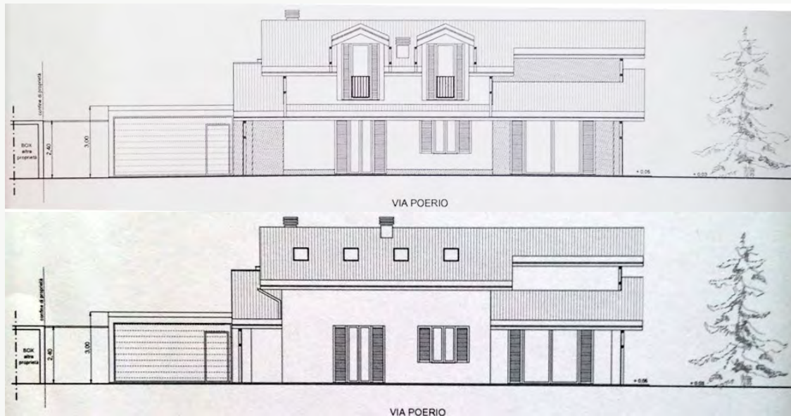
Figura 8 – Realizzazione di villa unifamiliare in Rho: le prescrizioni della commissione richiedono l'eliminazione degli abbaini sul fronte strada (a favore di lucernari) sia perché di dimensioni tali da risultare poco proporzionati all'edificio in progetto, sia perché rappresentano un elemento estraneo al contesto di progetto
