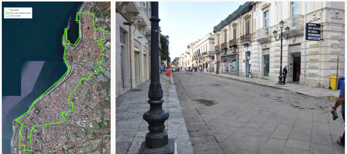
Figure 1-2 – Foto aerea della città con l'indicazione in verde del perimetro dell'area oggetto del vincolo (a sinistra) e Corso Garibaldi a Reggio Calabria, caratterizzato da pavimentazione storica in pietra di Macellari (marciapiedi) e in pietra lavica dell'Etna (sede stradale)
